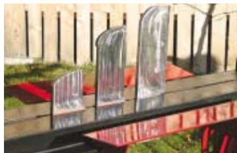
Starfort bietet drei verschiedene Messerlängen aus Feinkornstahl zum Spalten unterschiedlicher Holzarten an. Die roten Tischplatten verhindern, dass die Spalthälften zu Boden fallen.
