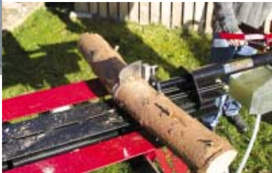
Fichten bis zu einem Durchmesser von etwa 15 cm lassen sich auch quer durchtrennen.
