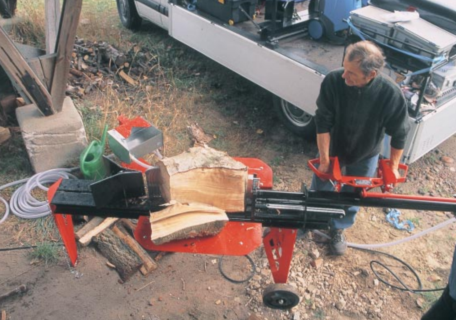
Abb. 1: Paul Stubenruss führt den Holzteufel vor. Gut zu sehen sind das Spaltnesser und der Spaltkeil. Die Seitenbleche sorgen dafür, dass die Spalthölzer nicht auf den Boden fallen. Am Boden steht der Wasser-Auffangbehälter.
