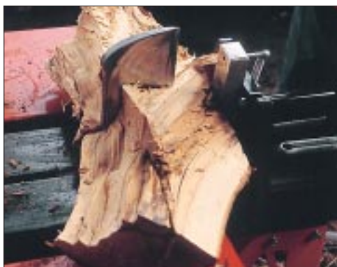
Abb. 2, oben: Hölzer bis etwa 20 cm Durchmesser kann der Holzteufel ohne Probleme auch quer spalten.
